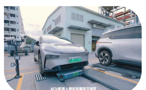
车辆被机器人自动运回交接区
