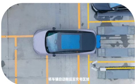
AGV机器人稳稳托起车辆，送入充电区域
