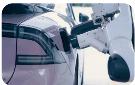
充电机器人自动为车辆充电
